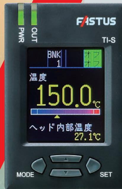
IO-Link対応 非接触温度計
